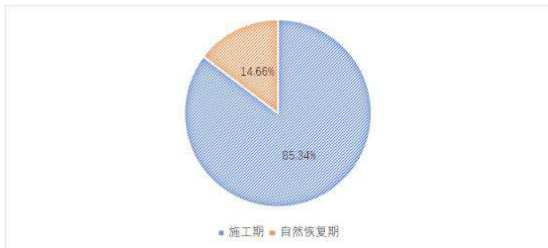
图 4.3-1 不同预测时段水土流失总量比较图
